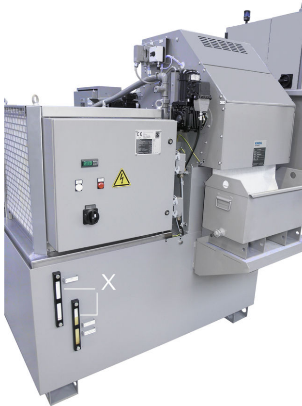
Füllstandsanzeige an einer Kühlschmierstoff-Aufbereitungsanlage (Fa. Knoll)
