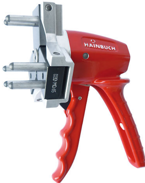
Beispiel: Manuelle Wechsellvorrichtung (Fa. Hainbuch)
