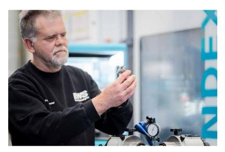
Links: Auf einer Wälzprüfmaschine direkt neben der INDEX G220 werden die eben zerspanten Kegelräder geprüft. (Fotos: EWS)
